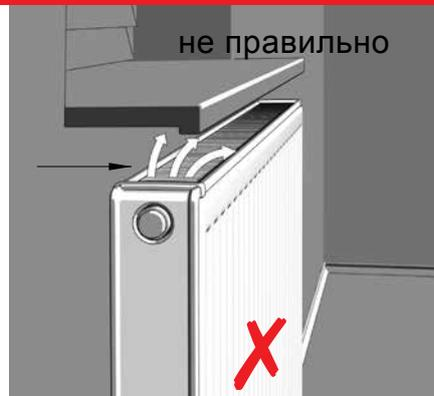
100% теплоотдача достигается только тогда, когда сверху и снизу радиатора нет предметов, препятствующих воздушному потоку. Когда под радиатором и над радиатором оставлены отступы. Верхний отступ можно просчитать как глубина радиатора плюс 10 % :
